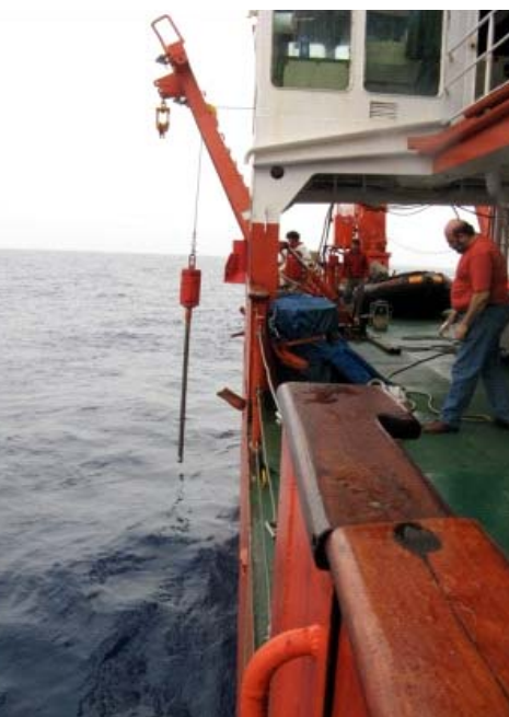
Trabajos de tomas de muestras con el testigo de gravedad a bordo del buque oceanográfico Hespérides
